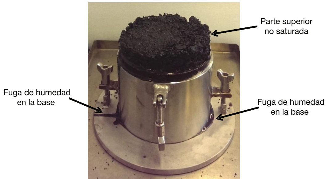
Figura 1.5.5.3.4.2: Ensayo en el que se muestra una fuga de agua procedente de la base del molde cilíndrico, lo que indica migración de la humedad
