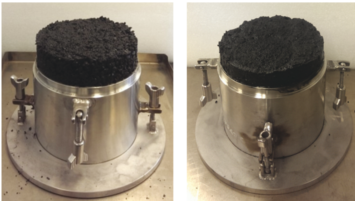
Figura 1.5.5.3.4.1: Fotografías en las que se muestran ensayos válidos con una porción de ensayo parcialmente saturada (izquierda) y una porción de ensayo saturada casi en su totalidad (derecha)
