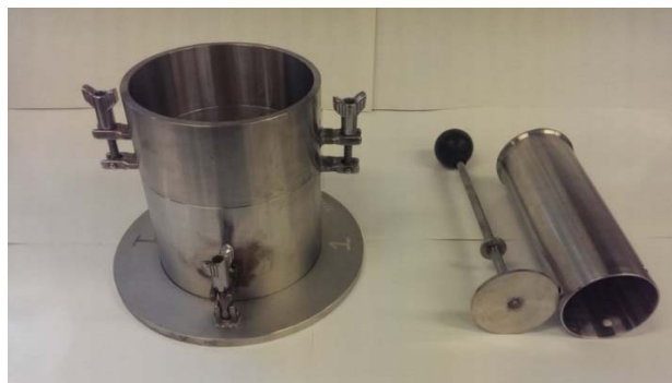
Figura 1.5.1: Ejemplo de aparato de ensayo Proctor/Fagerberg, del percutor y de la guía del percutor
