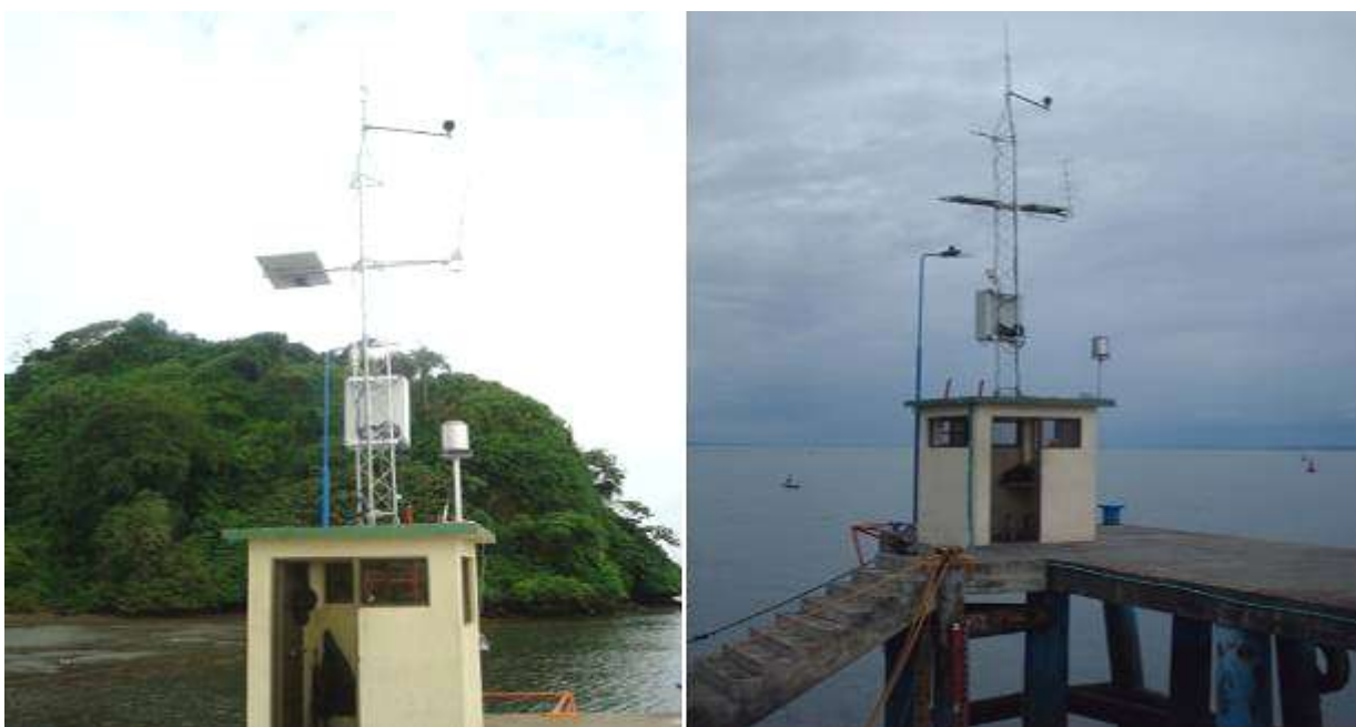
Estación de transmisión inalámbrica ubicada en el muelle de la Estación de Guardacostas de Tumaco, donde se reciben los datos provenientes del sensor.
