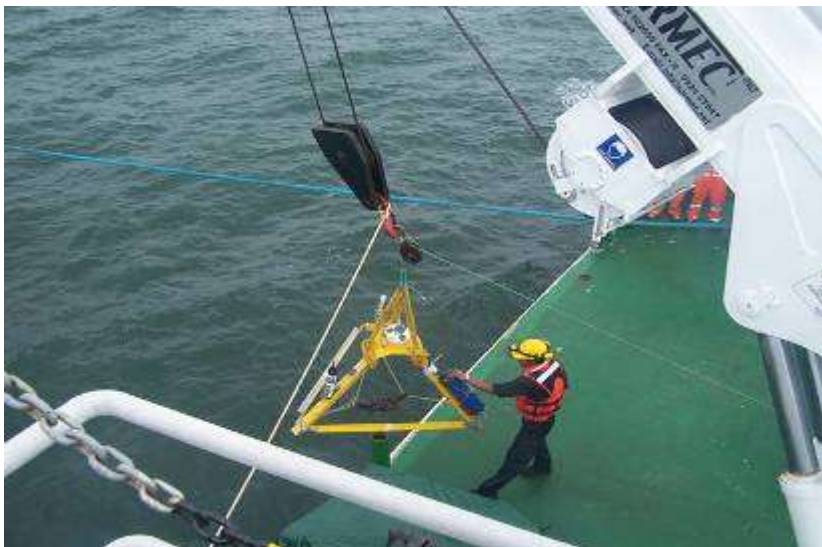
Maniobra con correntómetro ADCP a bordo del buque “ARC Gorgona”.
