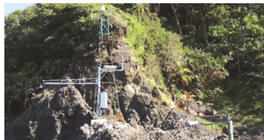
▶ Estación mareográfica y meteorológica Cartagena
