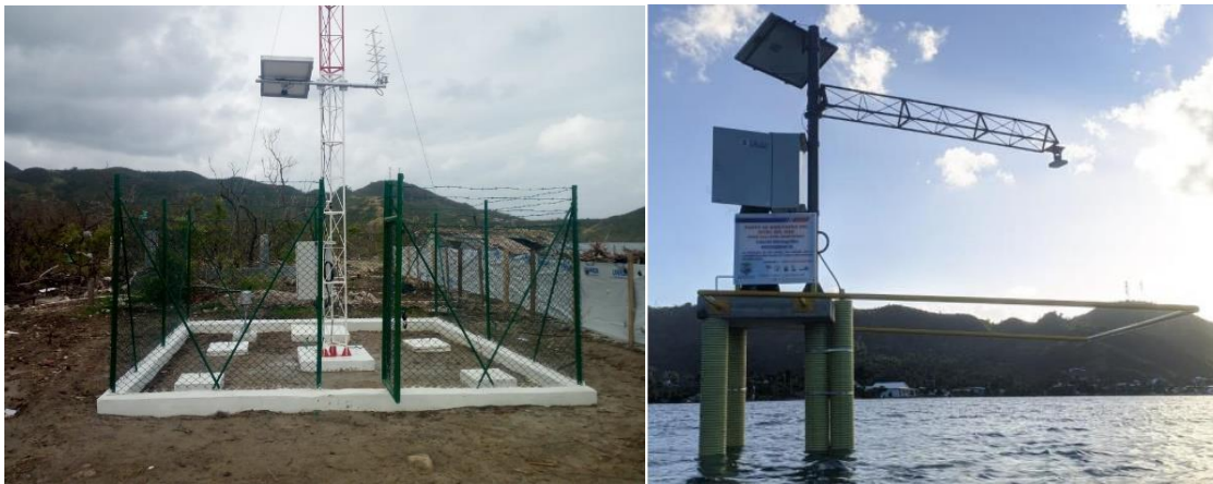
Figura 20 Estación Meteorológica y mareográfica de isla Providencia
