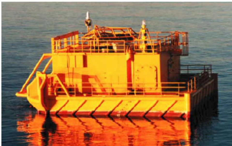
Figura 7. A. Boyas de amarre de pata de anclaje catenaria
