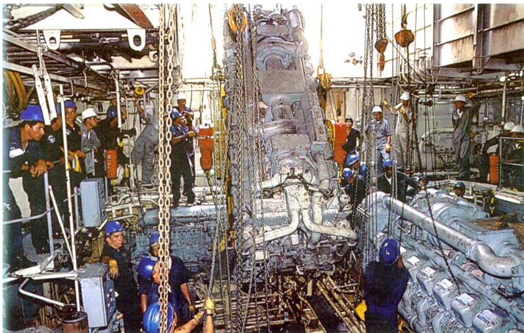
Extracción de los Motores Propulsores MTU de las Fragatas Misileras
